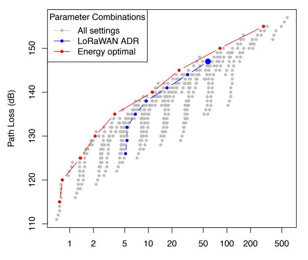
Transmit Energy per 32 byte message (uJ log scale)
